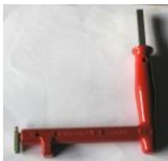
Abb. 31: Schlüssel zum Aushängen der Fensterflügel
