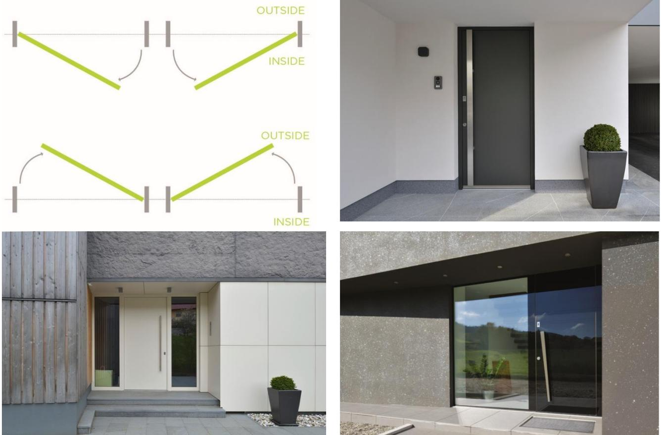
**Abb. 9:** Mögliche Öffnungsrichtungen bei Haustüren
