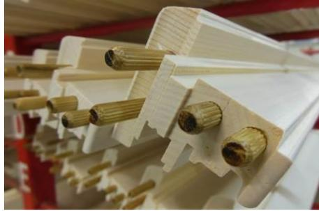
**Abb. 65:** Dübelverbindung der Fenster von M SORA
