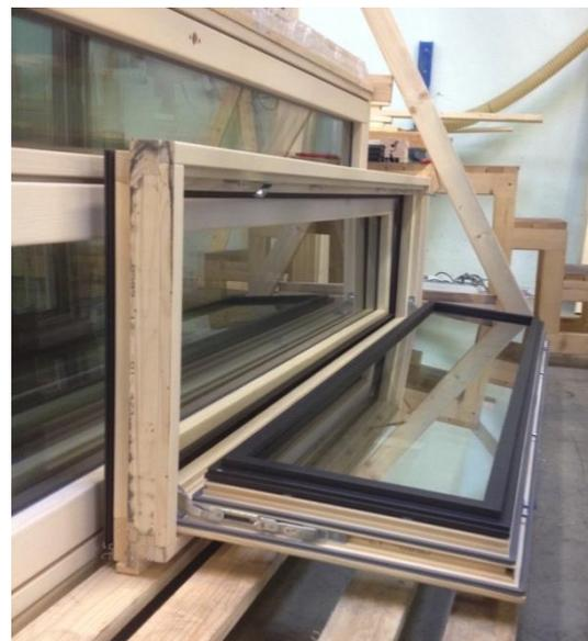
Abb. 51: Endposition – der Fensterflügel muss gestützt werden
